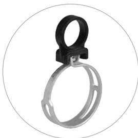
Una versión pre-abierta gracias a un clip de plástico desechable, que facilita el pre-montaje en el manguito, en la posición requerida mediante el encolado de la abrazadera. Es preciso consultar qué tipo de pegamento industrial se debe usar para una buena sujeción hasta la instalación final. Una vez que se ha presionado la abrazadera sobre el manguito se puede retirar manualmente el clip con facilidad.
