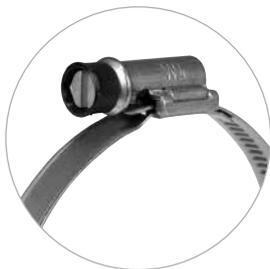
Le collier de sécurité NORMACLAMP® TORRO® 9/12 - 1043 0000 364 est formé d'une bande en plastique pouvant aisément être fixée sur la vis ou la tête du collier. En empêchant le tournevis de sortir de la tête, il facilite (safer) considérablement le processus d'installation. Le collier de sécurité est disponible pour les vis (screws) qui correspondent à une ouverture de clé de 7.
