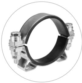
La version HMK NORMACLAMP® deux pièces version lourde possède une console dont les extrémités sont repliées et soudées par points sur la bande.
