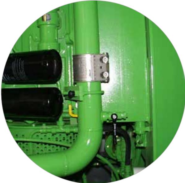
Les connecteurs de tubes FGR constituent un moyen compact, économique et fiable pour raccorder des tubes à extrémité lisse. Ils permettent de raccorder des tubes en plastique et en métal, et plus particulièrement les tubes en acier inoxydable. Ils peuvent être utilisés dans l'ingénierie mécanique et la construction, la construction de bateaux, le génie civil et hydraulique, la distribution et le traitement de l'eau.
