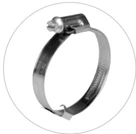
Cet élément permet de prépositionner le TORRO® sur le flexible. Les deux « dents » de ce dispositif maintiennent le collier TORRO® en place en toute sécurité pour le stockage ou le transport avant son montage final. Largeurs de bande disponibles 9 et 12 mm sur demande.
