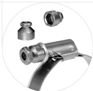
Le capuchon dynamométrique se rompt lorsque le couple admis est atteint et permet de faire l'économie d'une clé dynamométrique. La fente de serrage est de nouveau accessible après la rupture de sorte que le collier peut être démonté et/ou le cas échéant resserré.
