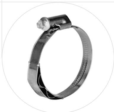
Le TORRO® est muni d'un ressort ondulé permettant un effet de resserrage automatique pour assurer une force de serrage radiale optimale. Par conséquent, le TORRO® constitue une solution optimale pour les applications soumises à des changements de température extrêmes (par ex. air chargé) ou pour le maintien des tuyaux ayant tendance à « glisser » (relâchement de tuyau)
