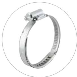
En comparaison avec les colliers de serrage à vis tangente, l'insert radial est un « collier à ressort » qui offre des capacités optimales de contraction et d'expansion. Il est adapté aux applications dans lesquelles le flexible subit des variations de température. Son design spécial assure un scellage fiable tout au long du cycle thermique. Disponible pour le TORRO® avec largeur de bande 9 mm.
