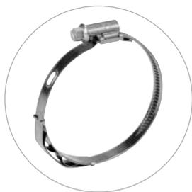
L'encoche constitue une autre possibilité ingénieuse de prépositionnement du TORRO® sur le tuyau. Dans ce cas, l'encoche de forme ovale trouve sa pièce antagoniste directement correspondante dans la bande du collier. Le TORRO® se maintient en toute sécurité et avec exactitude sur le tuyau avant le montage final. Largeurs de bande disponibles 9 et 12 mm avec différents angles sur demande.
