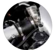
Son logement asymétrique offre une force élevée, un couple supérieur et la même distribution de pression de serrage. Le collier s'aligne parfaitement sur le tuyau et assure l'étanchéité optimale de la connexion.
