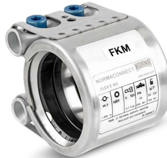
Die NORMACONNECT® FGR Rohrkupplung mit FKM-Manschette eignet sich zur Verbindung von Rohrleitungen wie Dampfleitungen mit einem Außendurchmesser von 33,7 mm bis 168,3 mm und einem Temperaturbereich von -10 °C bis +150 °C oder bis +180 °C für den Transport von Flüssigsubstanzen.
