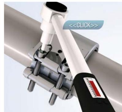
**3** Verbindungsbolzen mit einem Drehmomentschlüssel festziehen.
